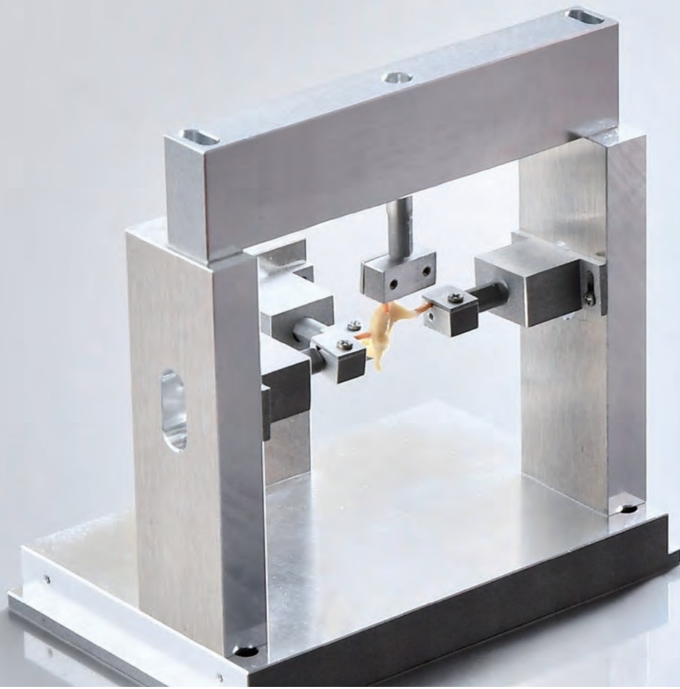
中央、耳小骨可動性計測装置のプローブ（探針）。振動する圧電アクチュエータと力センサが内蔵されている。プローブ先端で骨を触って伝わる力の変化を計測することで、耳小骨を支える筋腱の硬さと耳小骨の動きやすさを数値化して測定できる。
