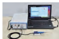
清水さんが使う耳小骨可動性計測装置。プローブをより耳小骨にアプローチしやすくするために挿入角度を変えた場合の、重力の影響の有無や計測結果の正確さを検証している。大学院生の先輩と共同で行うこの研究は、医療現場はもちろん企業とも連携する注目のプロジェクトだ。
