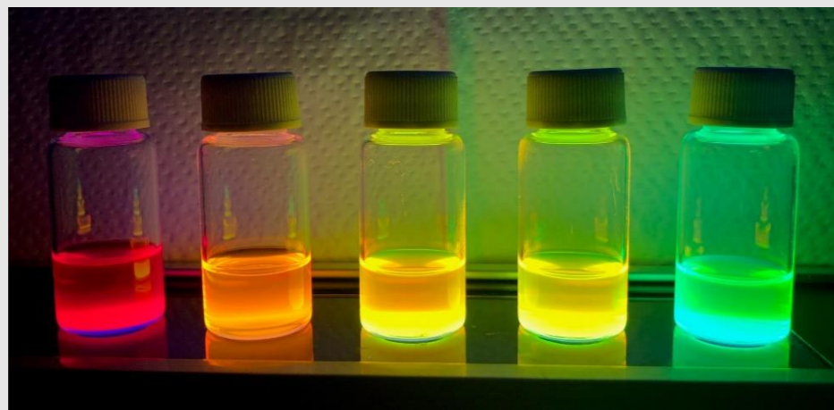
発光量子集約率100%のコロイド量子ドットの溶液 量子ドットのサイズを変えることで、光吸収と発光スペクトルを制御可能
