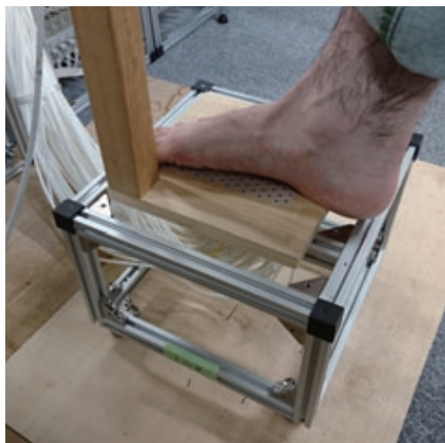
足裏に触力覚を提示する試作装置
