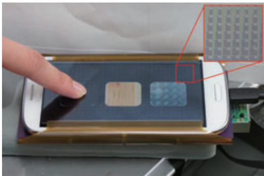
タッチパネル上の透明電極マトリクスを用いた触覚提示
