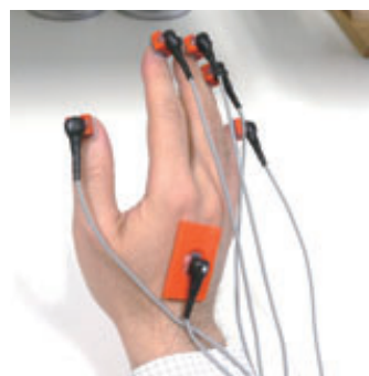
爪にセンサを取り付けた様子
