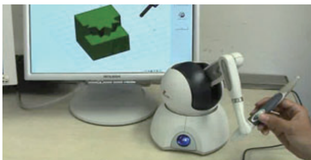
Haptic device を利用した5軸制御加工インタフェース
